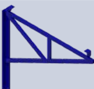
Plataforma de Trabalho sem Guarda Corpo
